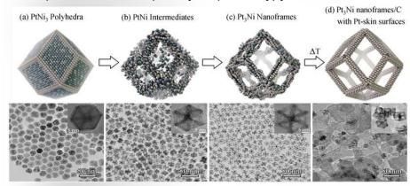
Оказывается, ребра нанокристаллов содержат гораздо больше активных центров на единицу поверхности, чем грани. В результате, электрокаталитическая активность фактически «пустых» наночастиц примерно в 3 раза превосходила активность обычных НЧ платины в расчете на единицу массы драгоценного металла. Стабильность таких наночастиц, по сообщению авторов, тоже оказалась весьма высока.
